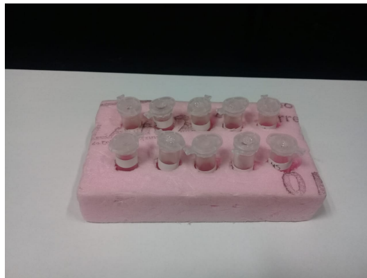
Figura 4.28: Muestras de Dynabeads para diferentes concentraciones a volumen constante de 50 \mu\text{l} en tubos eppendorf.
