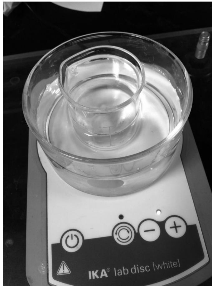
Figura 7-6. Procedimiento de enfriamiento del phantom mientras se continúa agitando para evitar asentamientos de componentes y garantizar homogeneidad, después de 2 minutos y medio adquiere una consistencia semi-sólida.
