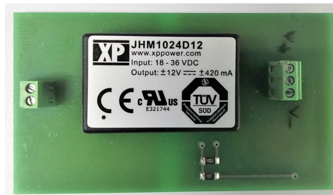
Figura 3.27: Implementación de la tarjeta impresa para el convertidor JHM1024D12.
