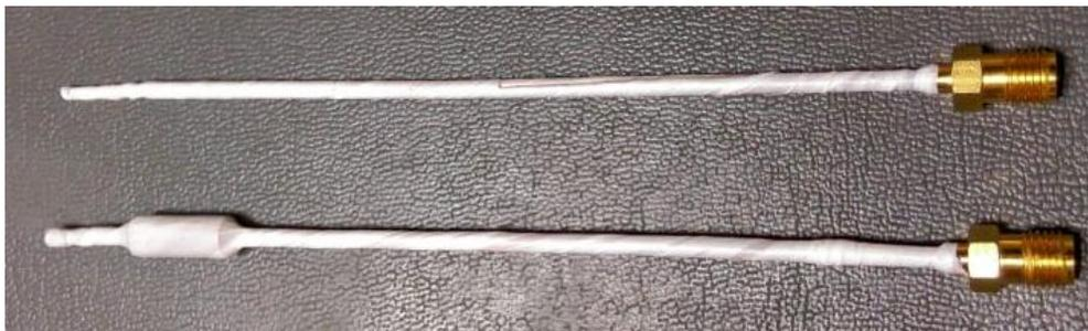
**Fig. 8.7.** Antenas MTM y DS-C con el recubrimiento de teflón.
