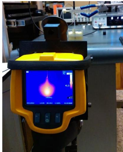
**Fig. 7.9.** Cámara termográfica Fluke Ti32 usada para la toma del patrón de calentamiento generado por las antenas.
