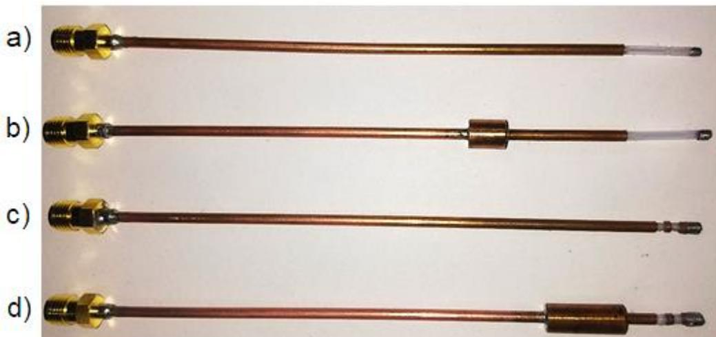
**Fig. 8.5.** Antenas propuestas. a) MTM, b) MTM-C, c) DS y d) DS-C.
