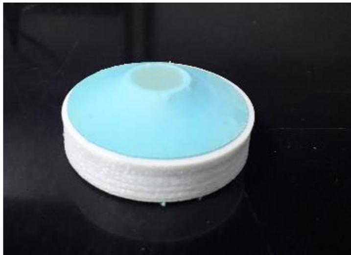
Fig. 6.1. Cono manufacturado dentro del laboratorio. Se muestra el empaque colocado con el componente de látex que contendrá el medio de propagación del ultrasonido (agua bidestilada).
