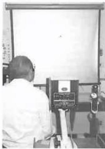
*Figura 2.5. Rotor de Kirschner.*
