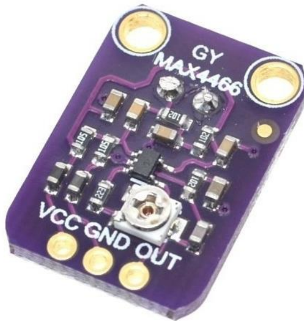
Fig. 20. Módulo Max4466 para preamplificación del micrófono.
