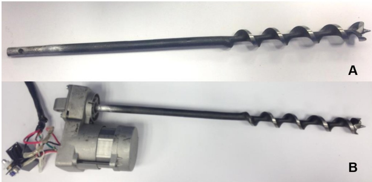
Fig. 15. Diseño final del husillo A)Modificaciones realizadas a la broca. B)Husillo colocado en el motor.
