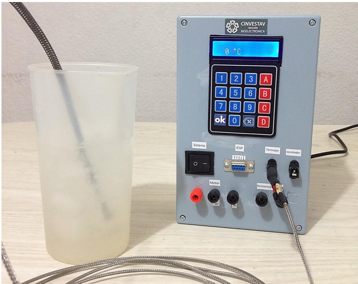
Fig. 43. Pruebas de precisión del sistema de medición de temperatura.
