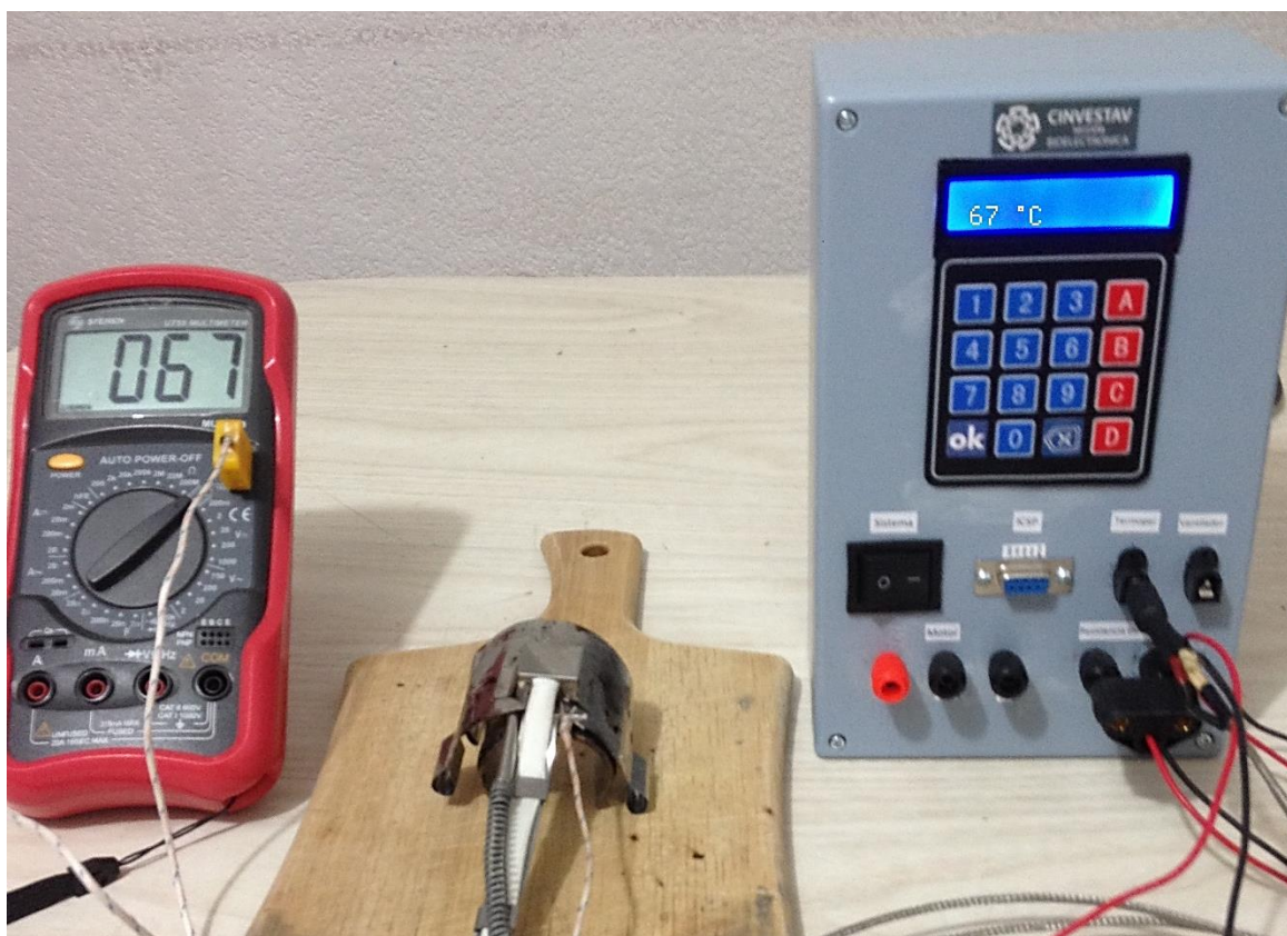
Fig. 40. Pruebas de exactitud del sistema de medición de temperatura.
