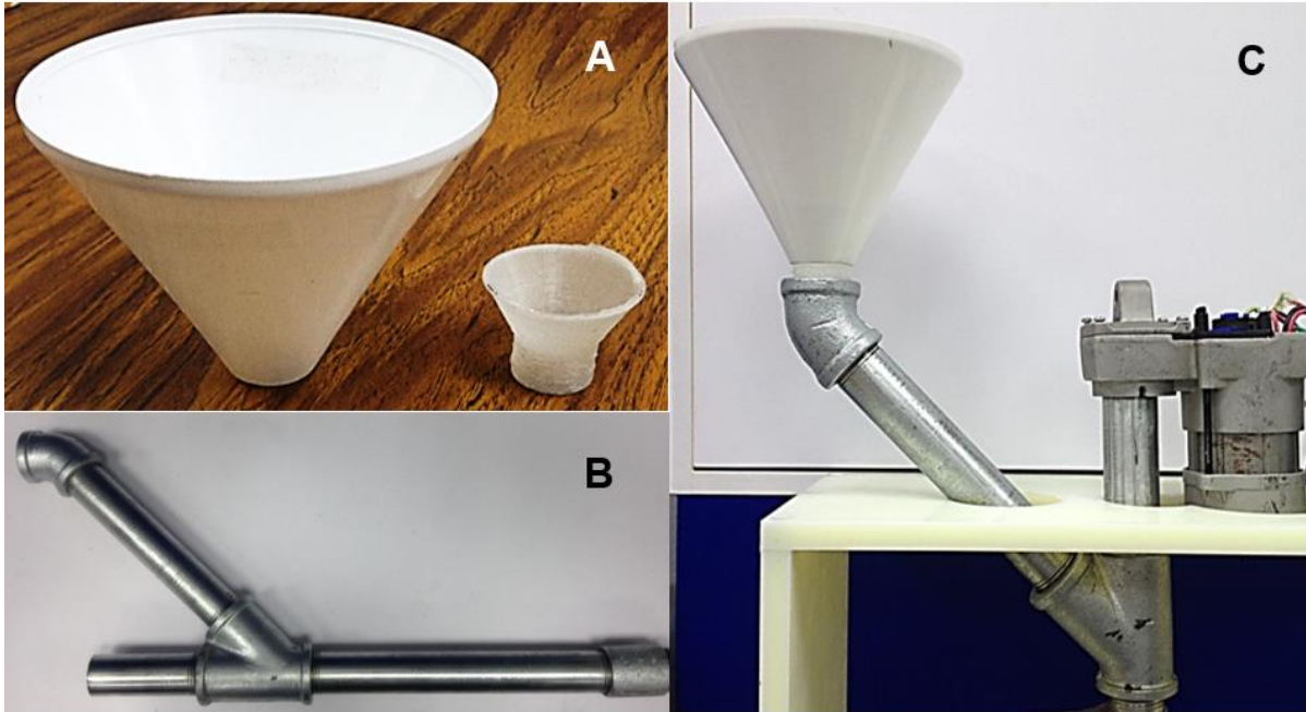
Fig. 17. Diseño final de la tolva. A)Pantalla cónica y adaptador. B)Canal de alimentación conectado a la camisa. C)Tolva ensamblada.
