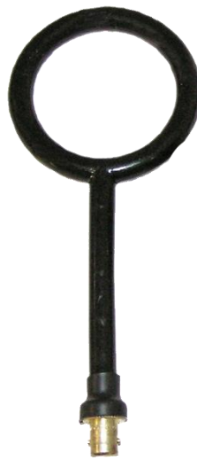
Fig. 5.5. Sensor de campo magnético ETS-EMCO 7405.
