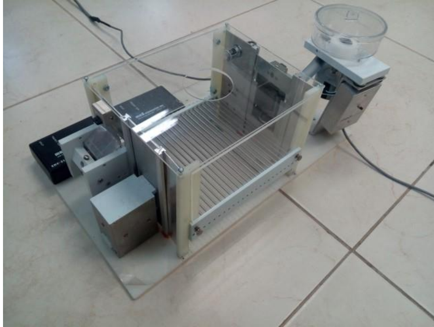
Fig. 24 – Caja conductual terminada, el ensamble se hizo sobre una placa de acrílico que fija la caja, los dispositivos de control, los puertos y el dispensador de pellets.
