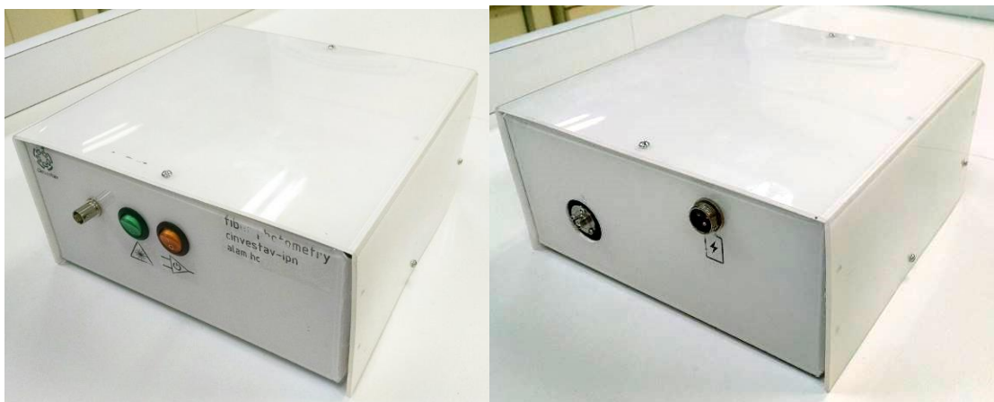
Fig. 20- Fotografía del dispositivo terminado, se observa la salida por conector BNC y los interruptores de encendido para la estimulación láser y el circuito de amplificación del fotodiodo de avalancha (Izquierda) y parte trasera de la carcasa, con el conector tipo FC para fibra óptica y el conector para la carga de la batería.
