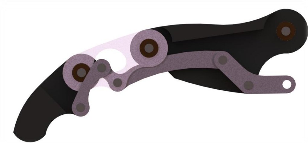
Fig. 46 Diagrama de los 6 eslabones del dedo (Ensamblado) Corte Medio
