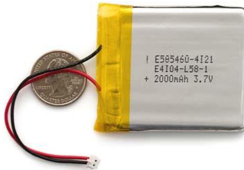
Fig. 39 Batería Litio Polonio (LiPo) 3.7 V@2000 mAh
