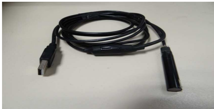
Fig. 3.10.- Equipo para la retroalimentación visual. a) Endoscopio flexible (Pentax) desmantelado (cuerpo). b) Boroscopio USB.
