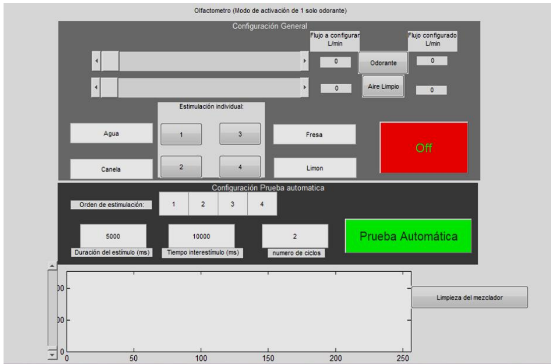
Fig. 14 Ventana de la interfaz de prueba para ciclos automáticos de estímulos.
