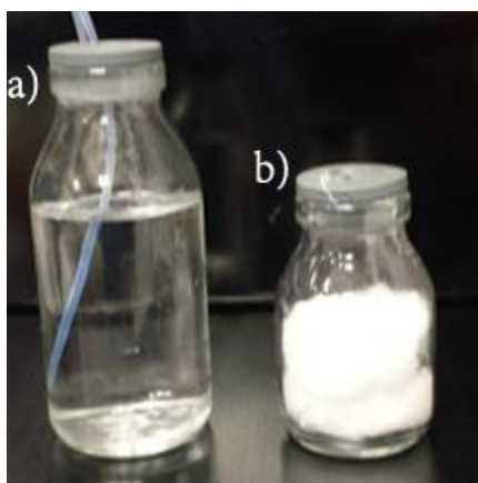
Fig. 7 Contenedores para muestras odorantes a) muestras líquidas b) muestras sólidas.
