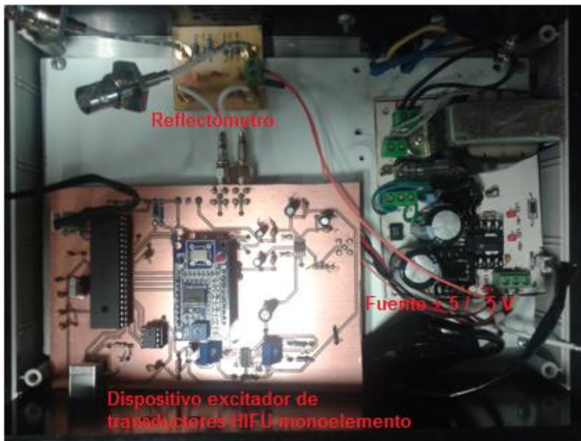
Fig. 94. Dispositivo excitador de transductores HIFU monoelementos con reflectómetro incorporado.
