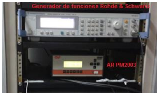
Fig. 85. Generador de funciones y medidor de potencia utilizado.
