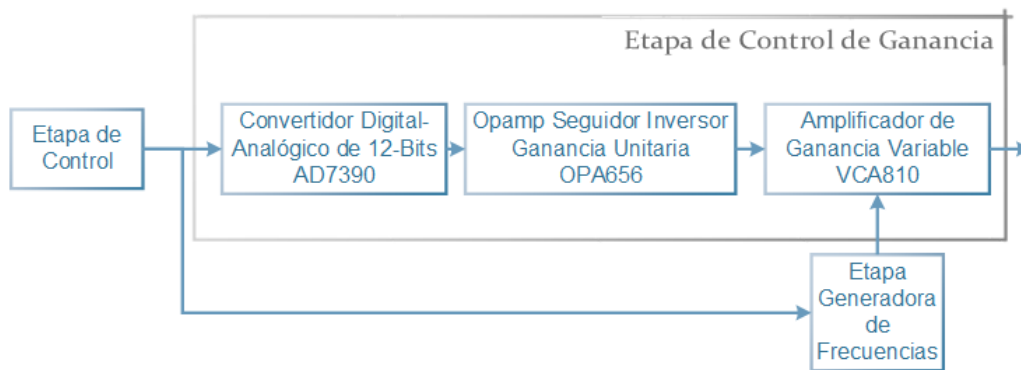
Fig. 55. Diagrama de la etapa de control de ganancia.
