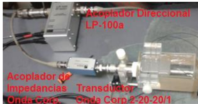
Fig. 87. Acoplador direccional y Transductor con su acoplador de impedancias utilizados.
