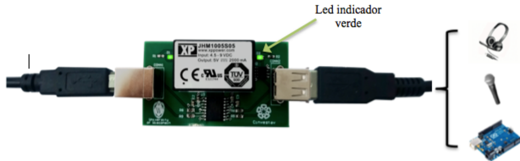
Figura 38. Led indicador verde cuando se conecta un dispositivo full-speed .
