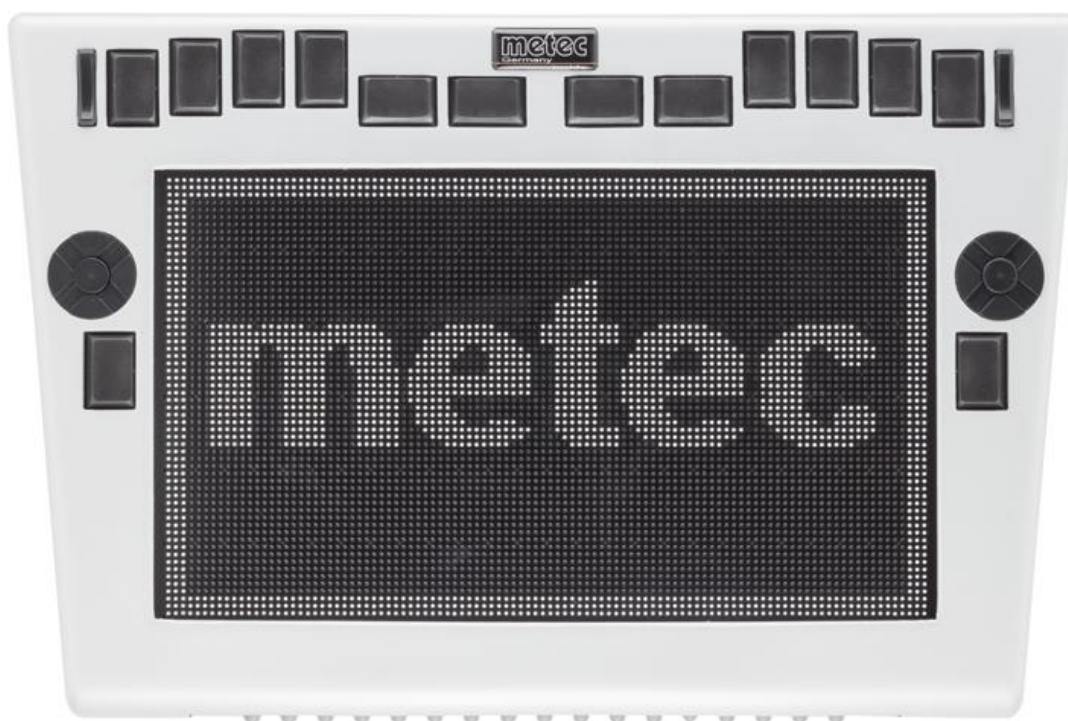
Fig. 6 HYPERBRAILLE S DISPLAY 6240 (display braille para la visualización táctil de diferentes figuras)
