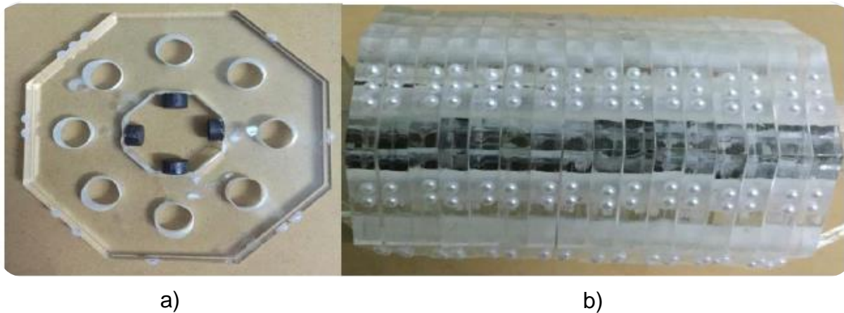
Fig. 8 a) disco octogonal que compone las combinaciones posibles de media celda braille, b) sistema octogonal ensamblado
