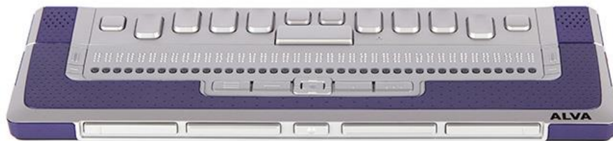
Fig. 3 ALVA BC640 (terminal braille para navegación en el ordenador)
