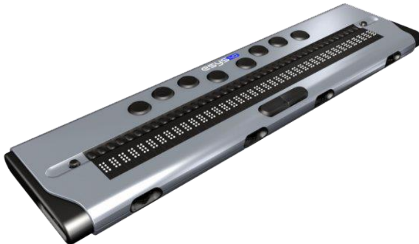
Fig. 4 ESYS 12 (terminal braille para navegación en el ordenador)
