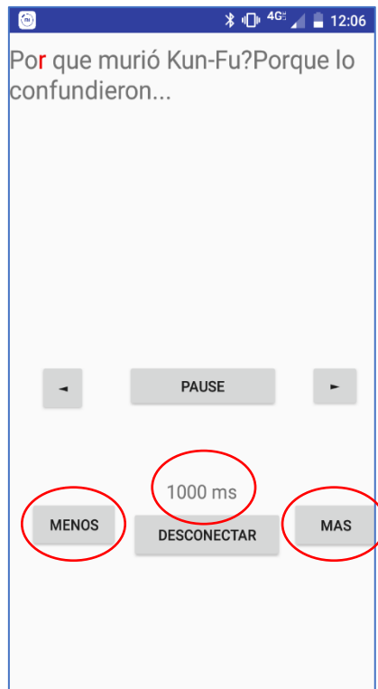
Fig. 28 Interfaz parta lectura (los círculos rojos indican los botones para aumentar o disminuir la velocidad de lectura y el tiempo configurado)
