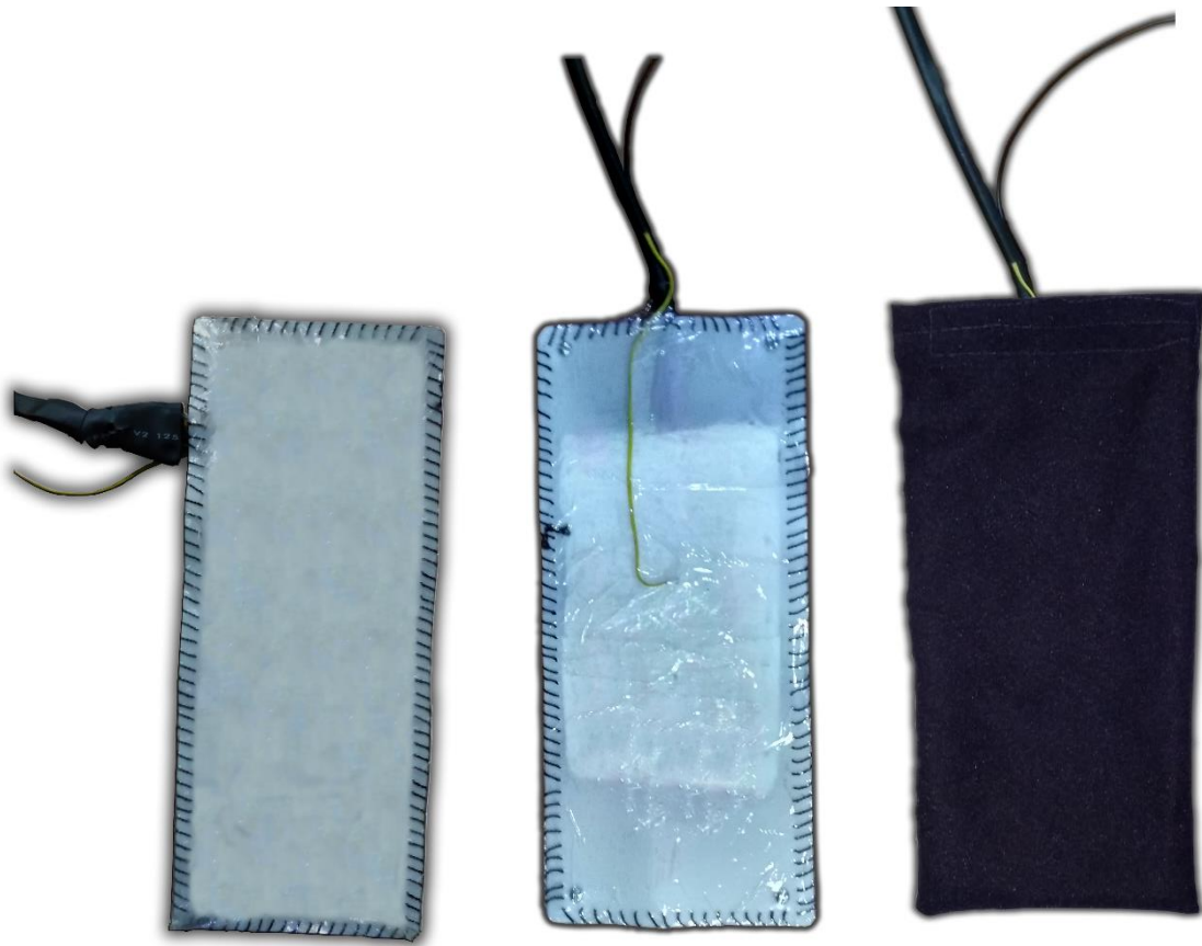
Figura 50. A la izquierda, primera versión del pad con cables ubicados a un costado, en medio, el pad con cables en la parte superior, a la derecha, cubierta de tela para mejor estética.
