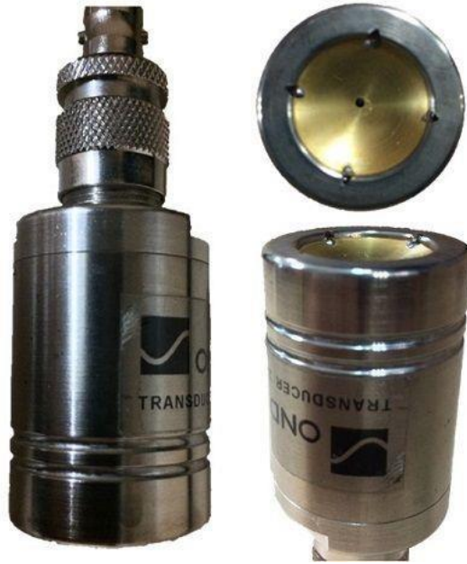
Fig.5.13. Transductor FUS Onda Corporation® utilizado para la experimentación. Se observa la cara curva del transductor, el cual va a generar la focalización del ultrasonido.
