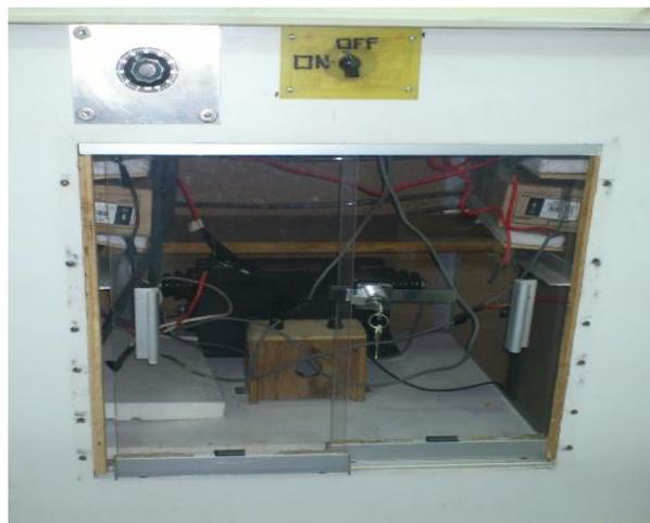
*Figura 12.- Fotografía del generador de alta tensión elaborado en el laboratorio.*
