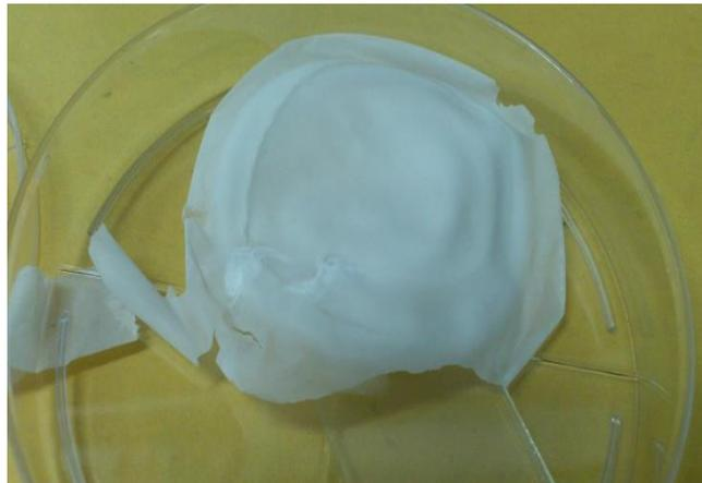
*Figura 20.-Membrana de Nylon-6 obtenida por electrospinning*
