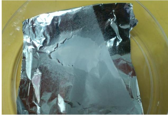
*Figura 19.-Membrana de PVDF obtenida por electrospinning*
