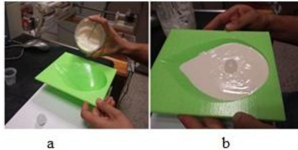
Fig. 4. 4. (a) Vertido del *phantom* de seno en el molde. (b) Colocación del *phantom* de cáncer de seno dentro del *phantom* de seno.
