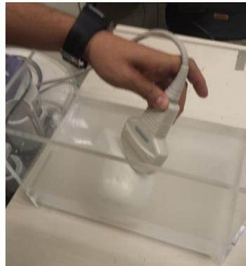
Fig. 4. 6. Escaneo de los *phantoms* de seno y de cáncer de seno con sonda convexa.
