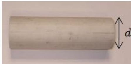
Fig. 11. 5. Cilindro con diámetro  $d = 33.20 \pm 10 \text{ mm}$  utilizado para medir la exactitud del sistema.
