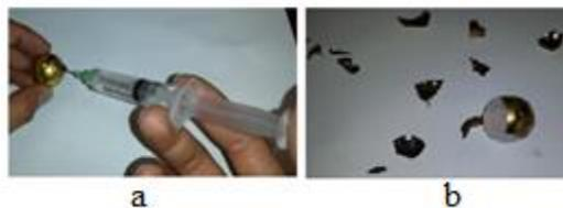
Fig. 4. 3. (a) Vertido del *phantom* de cáncer de seno en la esfera. (b) Removimiento del molde de esfera.
