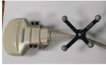
Fig. 6. 3. Sonda *US* convexa con cuerpo rígido.
