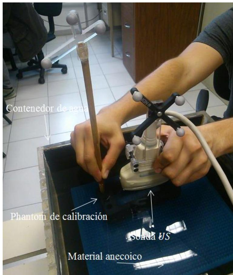
Fig. 10. 7. Calibración de la sonda *US* de donde se extraen los cruces de los hilos del *phantom* de calibración.
