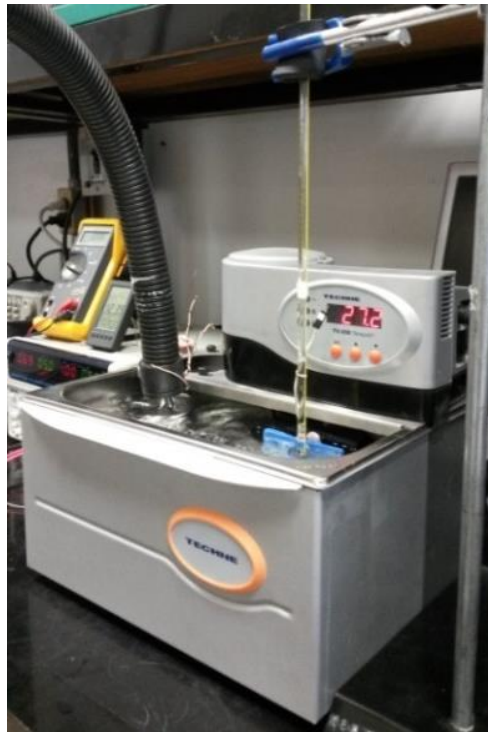
Figura 3.8. Sistema para la obtención de la curva de caracterización de los termistores, en donde se observa la tina con agua y el termorregulador, así como el termómetro de mercurio, el sensor y la manguera del enfriador.
