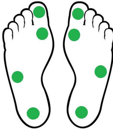
Fig. 6.2 Zonas que se medirán con el sistema de monitoreo de temperatura de pie diseñado
