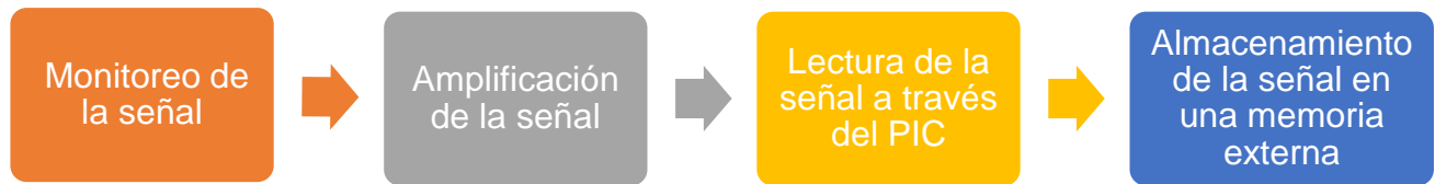
Fig. 3.12 Etapas correspondientes a la adquisición de la señal del sistema de monitoreo de temperatura en pie
