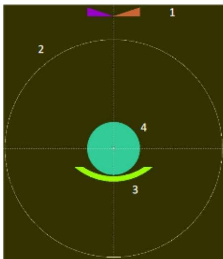
Figura 3.2: Muestra la geometría que se utilizará para simular el sistema de TC. 1) Filtros "bowtie", 2) Anillo de detectores, 3) Soporte del paciente, 4) Objetos a escanear.
