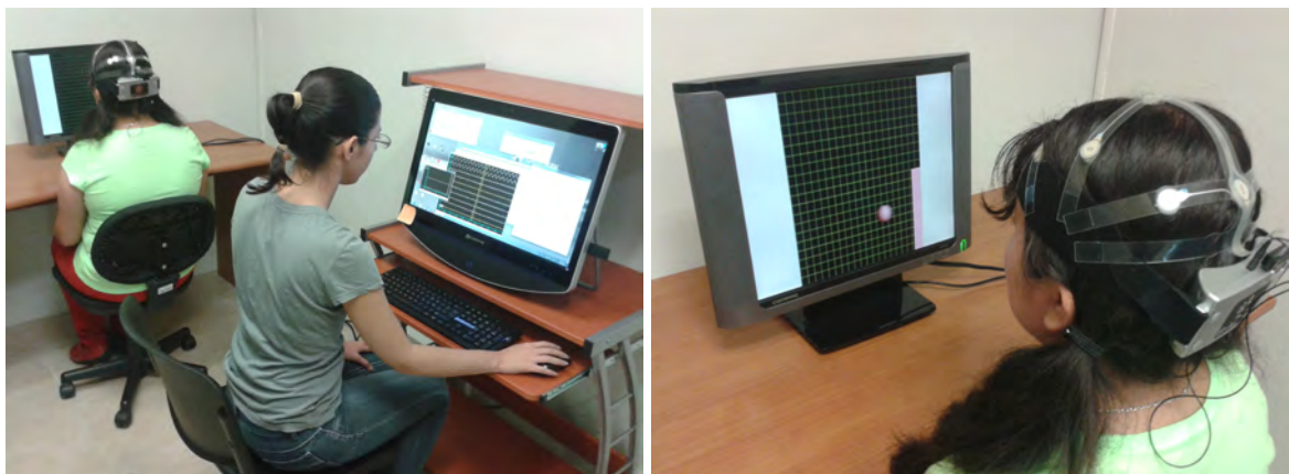
(a) Sujeto de prueba e investigador durante la adquisición del EEG. (b) Sujeto realizando la tarea de control de un cursor con retroalimentación visual.
