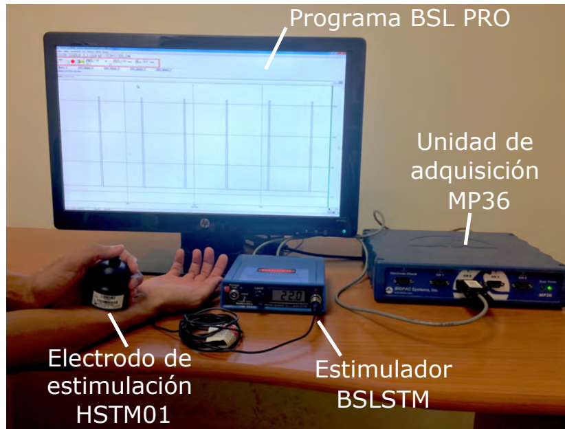
Fig. 3.2: Elementos del sistema empleado para administrar FES.
