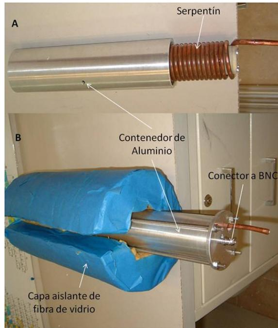
**Figura 3.3.** (A) Capacitor cilndrico cubierto por serpentín dentro de un contenedor de aluminio, (B) aislado a su vez por una capa de fibra de vidrio.
