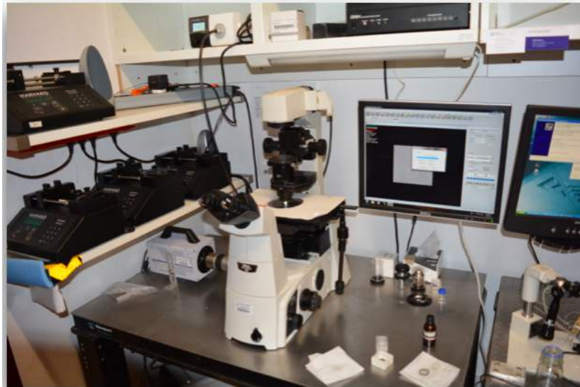
Figura 13: Arreglo experimental: Microscopio Nikon Eclipse Ti y objetivo de contraste de fase 100x. Cámara: Photron, FastCAM SA3
