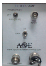
Figura 5.4: Interfaz de conexión del preamplificador
