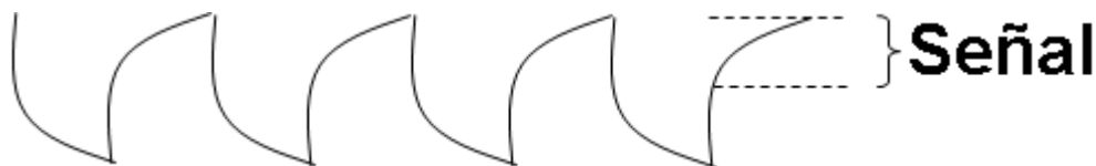
Figura 5.6: Señal de respuesta de una sonda platinizada
