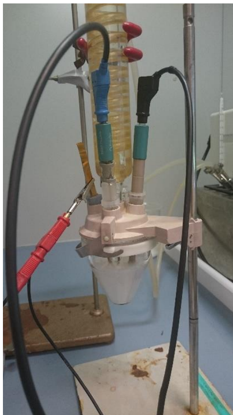
Figura 5.13. Celda electroquímica utilizada para el estudio del electrolito mediante voltametría cíclica.
