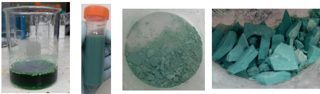
Figura 7. Izquierda a derecha: solución de mezcla de reactivos, dispersión del producto al término de la reacción, MOF recuperado sin lavar
