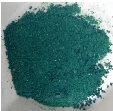
Figura 8. MOF MIL-101(Cr) pulverizado.
