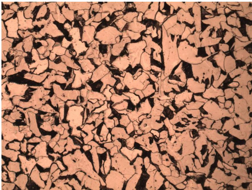
Figura 2.1. Microestructura de acero al bajo carbono: la región clara (ferrita) y la región oscura (perlita).
