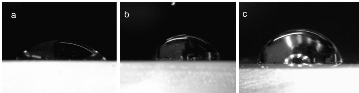
Figura 4.16. Ángulos de contacto de los tratamientos de superficie de acero al bajo carbono para los tiempos de 4 h (a), 24 h (b) y 120 h (c).
