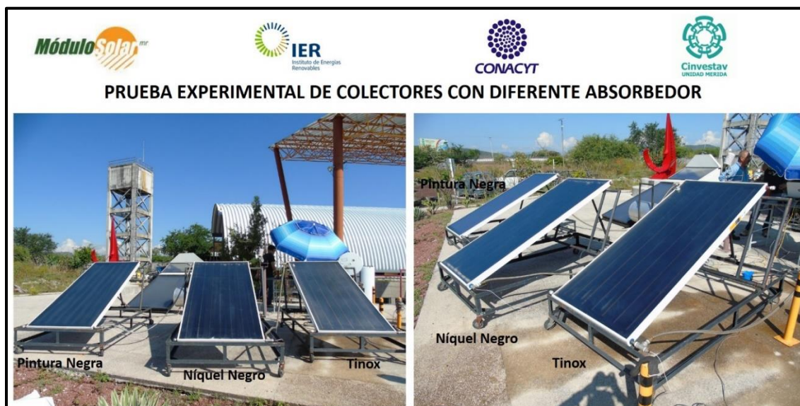
Figura 45. Colectores solares con diferentes recubrimientos selectivos, instalados en el laboratorio de pruebas de Módulo Solar S.A. de C.V.
