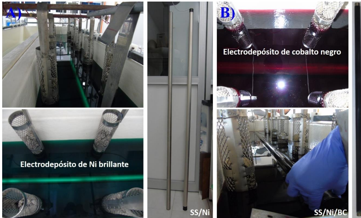
Figura 36. Escalamiento del recubrimiento selectivo de cobalto negro con reflector de infrarrojo níquel brillante en tubo de acero inoxidable 304. Depósito electroquímico y recubrimientos selectivos: A) Ni brillante y B) cobalto negro.
