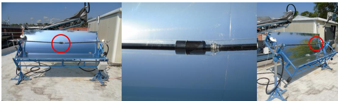
Figura 40. Problemas técnicos de montaje del tubo Cu/Ni/BC en el concentrador cilindro parabólico.
