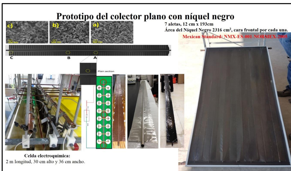
Figura 43. Esquema de depósito de recubrimiento selectivo de níquel negro en aleta.
