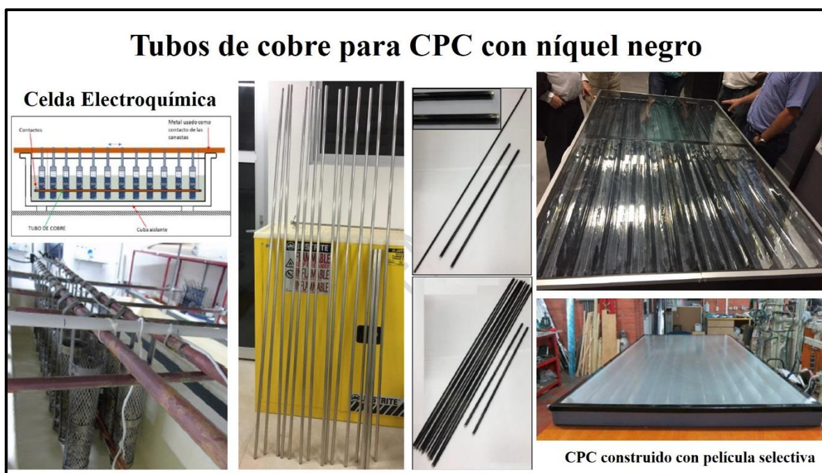
Figura 46. Esquema de construcción del prototipo CPC con el recubrimiento selectivo de níquel brillante y níquel negro.
