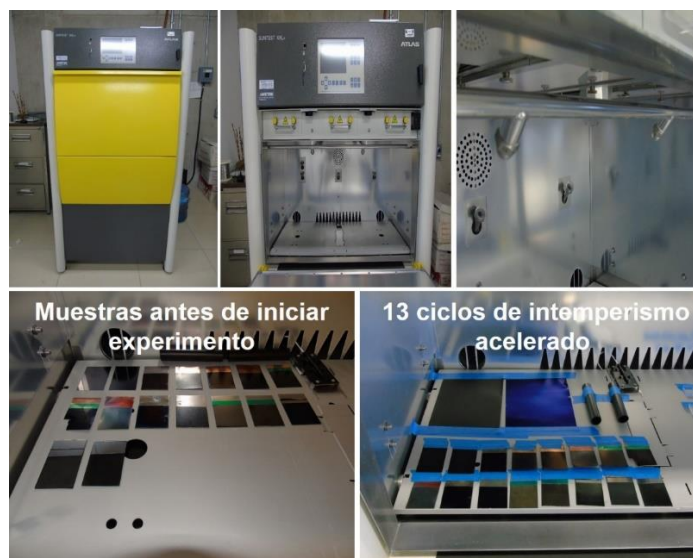
Figura 25. Pruebas de intemperismo acelerado en recubrimientos selectivos de cobalto negro.
