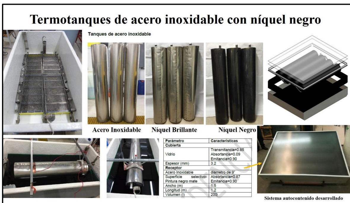
Figura 47. Esquema de construcción del prototipo de sistema autocontenido con el recubrimiento selectivo de níquel brillante y níquel negro.
