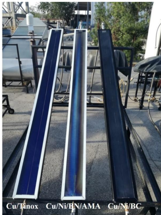
Figura 42. Sistema de medición de aletas individuales en el laboratorio de pruebas de la empresa Módulo Solar S.A. de C.V. en Xochitepec, Morelos.
