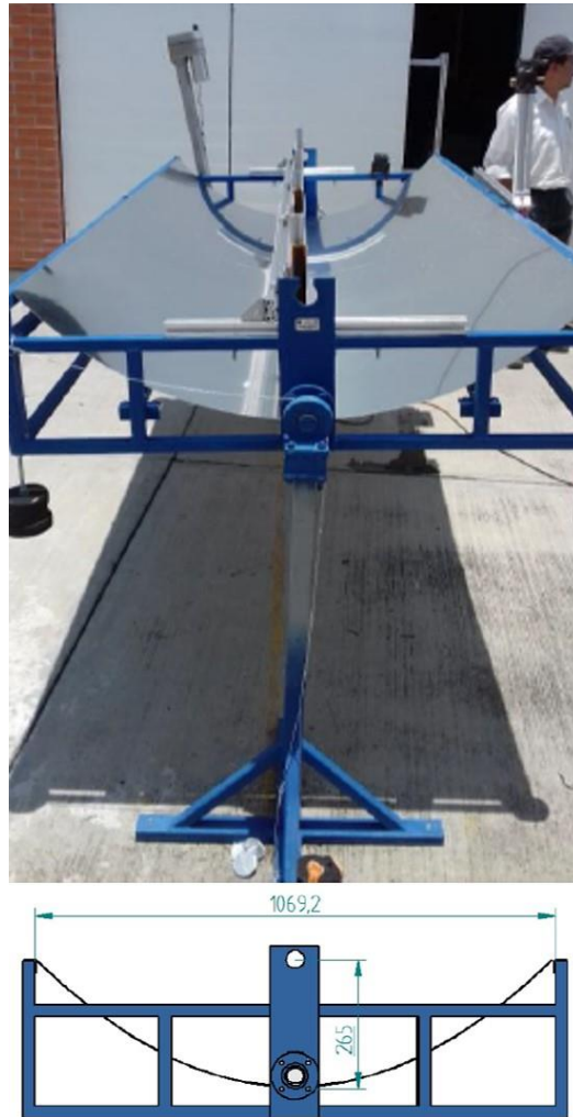
Figura 38. Prototipo de concentrador cilindro parabólico (CCP) del Instituto de Energías Renovables (IER-UNAM), Temixco; Morelos.
