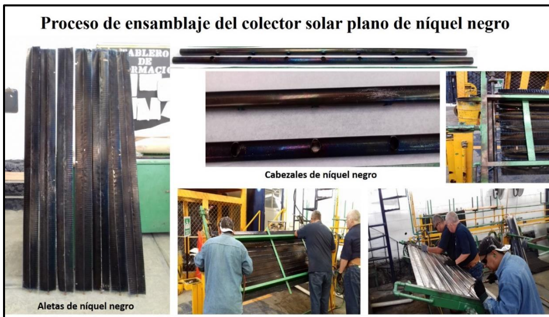
Figura 44. Proceso de ensamblaje del colector solar plano con superficie selectiva de níquel negro.
