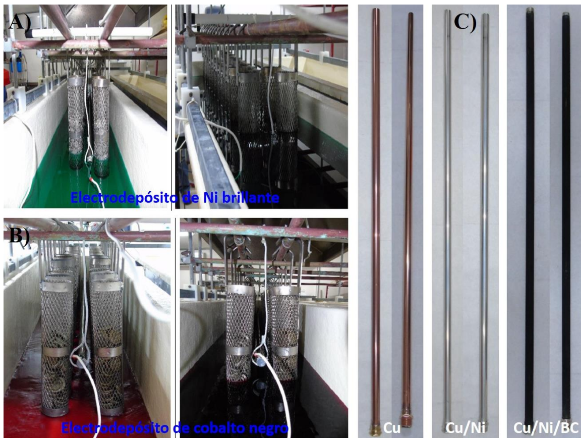
Figura 37. Escalamiento del recubrimiento selectivo de cobalto negro con reflector de infrarrojo níquel brillante en tubo de cobre. Depósito electroquímico: A) Ni brillante y B) cobalto negro, y en C) tubos de cobre con recubrimientos selectivos Ni brillante y cobalto negro.
