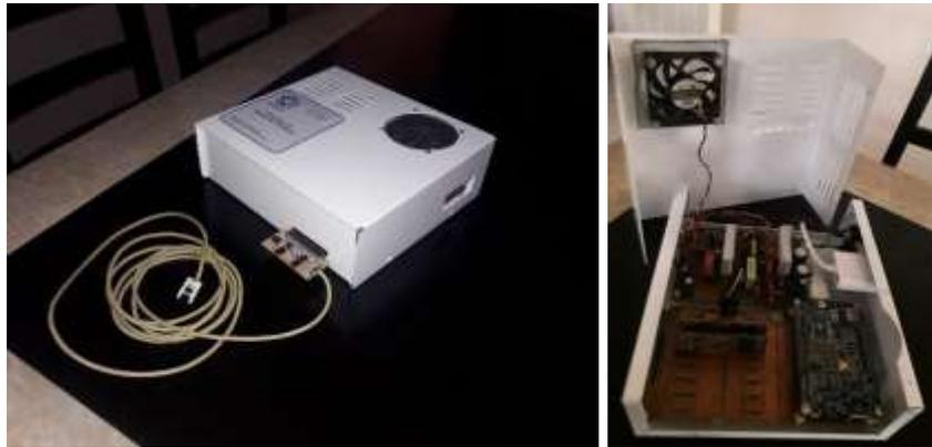
Fig. 32 Registrador con el electrodo conectado; del lado derecho una vista interna del circuito
