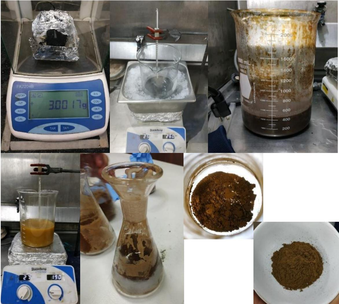
Figura. 31. Descripción de la síntesis de óxido de grafeno siguiendo el método de Hummers modificado. Adaptado de Hummers (*Hummers & Offeman, 1958*) por (*Mardiana et al., 2015*).
