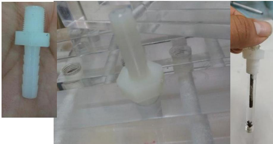
**Figura. 3.** Modificaciones a la celda y electrodos para ser utilizados en la *CESIM*. De izquierda a derecha se observa el conector utilizado y modificado, Los orificios adicionales elaborados con el conector y a la derecha el conector unido con el electrodo de referencia
