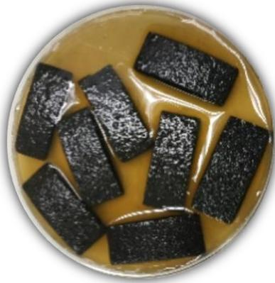
**Figura. 16 Se muestran los fragmentos de electrodo sumergido en la solución de GO 1mg/ml.**
