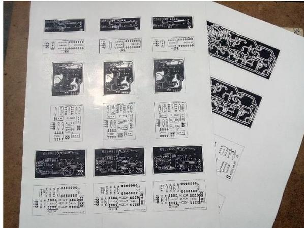
Figura B.1 Diseño de PCBs impresos en papel couché.
