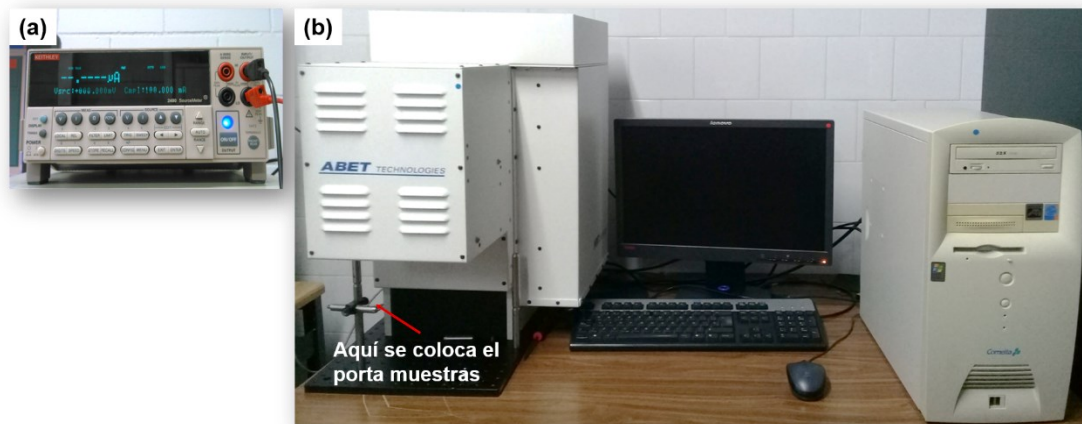
Figura 2.11 (a) Unidad de fuente-medida Keithley 2400. (b) Simulador solar de Abet Technologies modelo 11000 clase tipo A.
