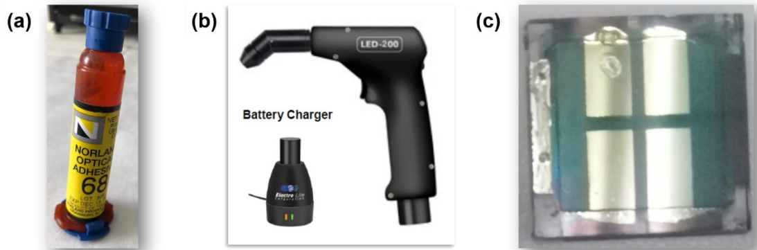
Figura 2.16 (a) Encapsulante, (b) sistema de curado puntual LED-200 UV y (c) celdas encapsuladas.
