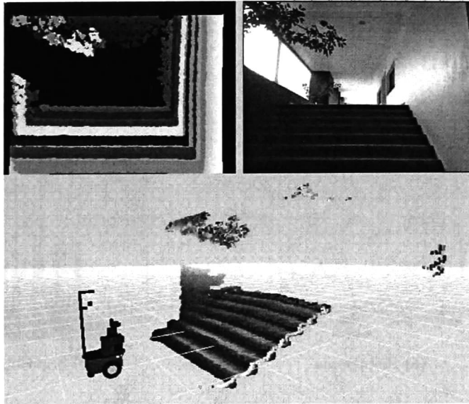
Figura 5.10: El robot móvil viendo una escalera, obteniendo los planos que la conforman y su representación en el ambiente virtual 3D.
