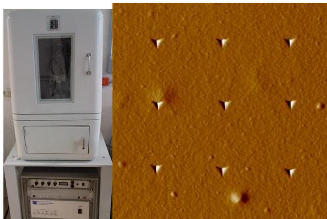
Figura 14. a) Nanoindentador Hysitron b) muescas en película de CS
