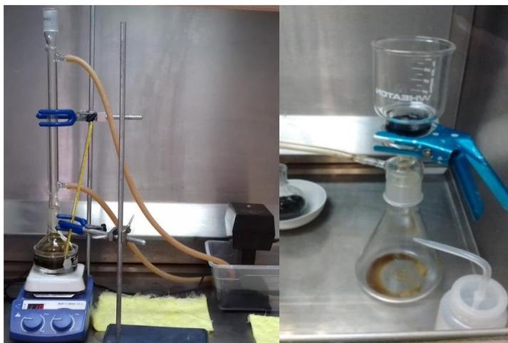
Figura 9. Método convencional de funcionalización de MWCNT a reflujo y filtrado a vacío
