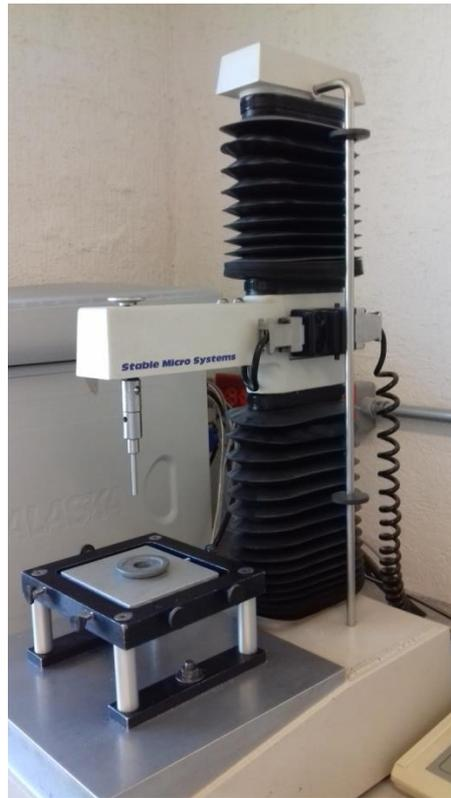
Figura 15. Texturometro para pruebas de tensión y compresión de películas.
