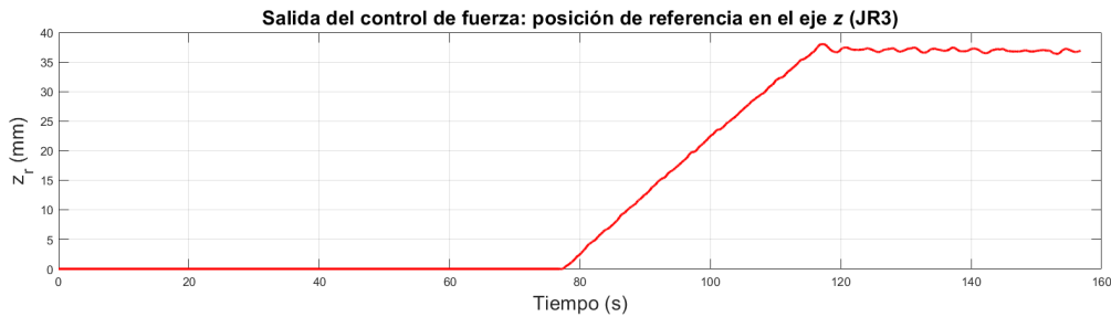
Figura 5.27: Posición de referencia en el eje z del robot JR3, experimento 3.
