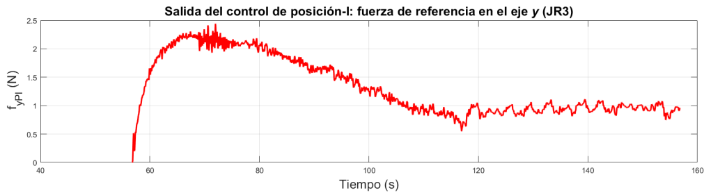
Figura 5.21: Fuerza de referencia en el eje y del robot JR3, experimento 3.
