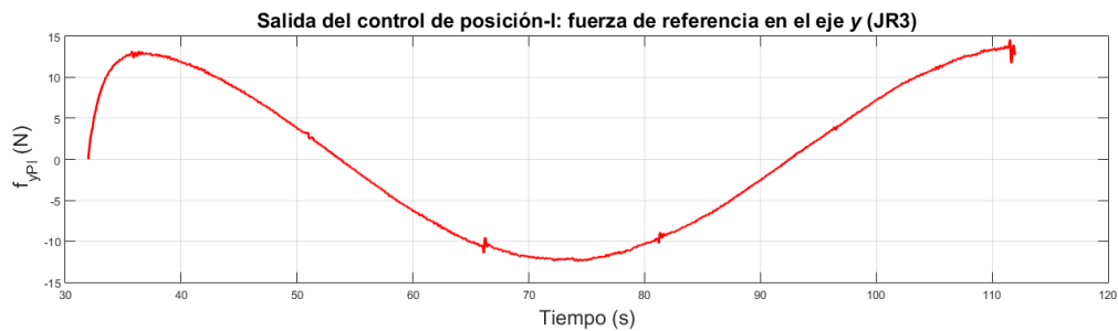
Figura 5.6: Fuerza de referencia en el eje y del robot JR3, experimento 1.
