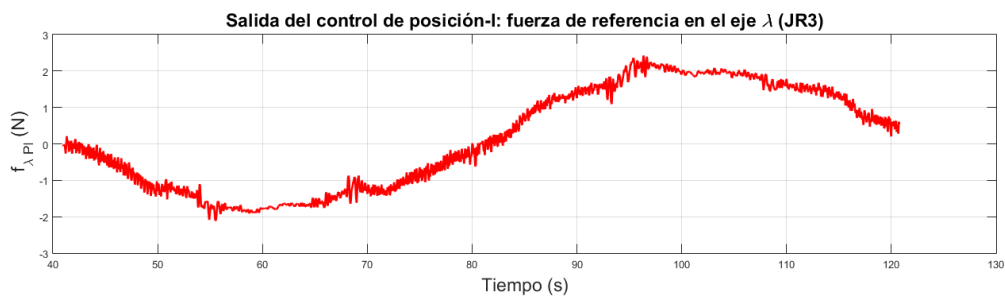
Figura 5.13: Fuerza de referencia en el eje \lambda del robot JR3, experimento 2.
