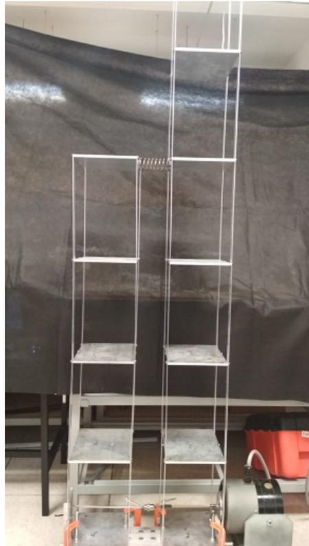
Figura 4.9: Edificios acoplados con un resorte.
