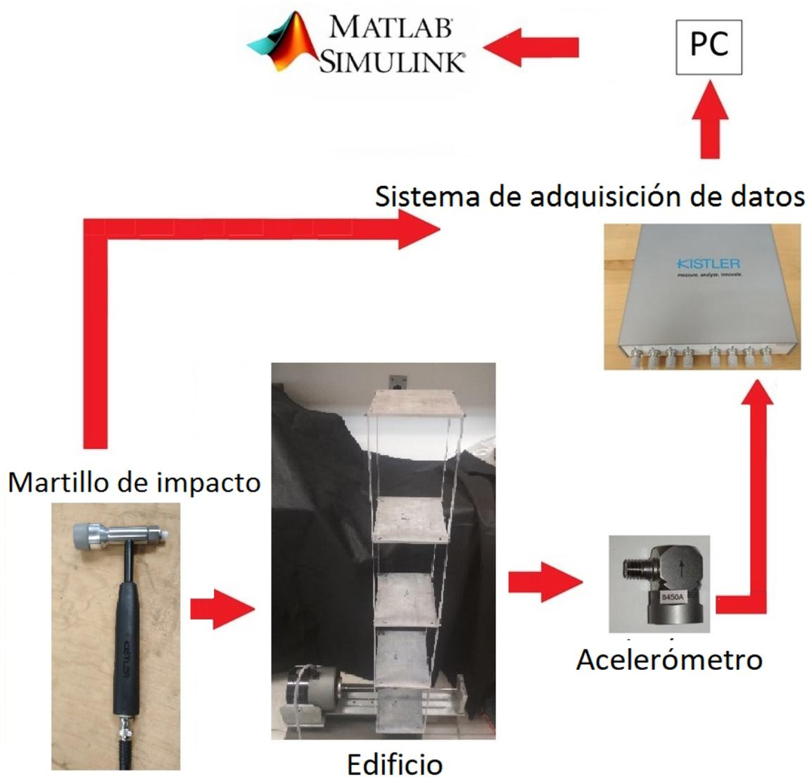
Figura 3.10: Arreglo experimental con martillo de impacto
