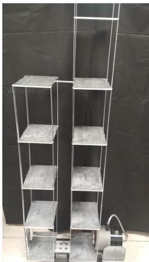
Figura 4.6: Edificios acoplados barra rígida
