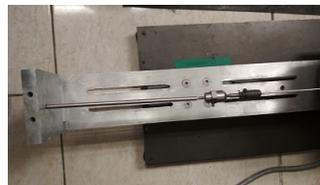
Figura 3.6: Base unidireccional sujeta por varilla a cabeza de impedancia Kistler.
