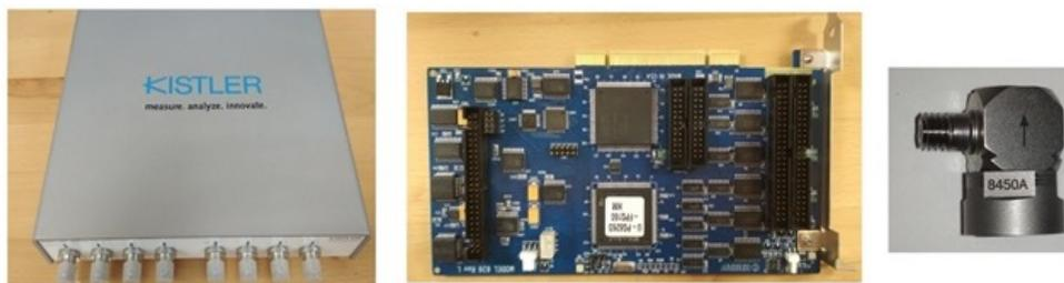
Figura 3.8: Sistema de adquisición de datos, tarjeta sensoray, acelerómetro
