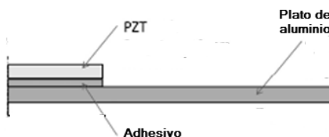
Figura 2.18: Adhesivo para parches piezoeléctricos de la marca Loctite.
