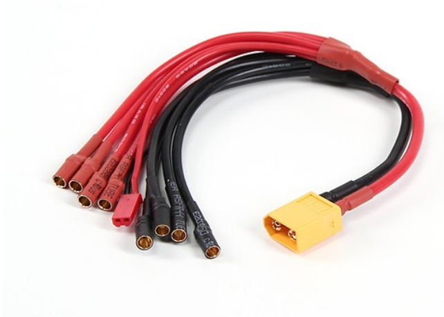
Figura C.12: Arnés de distribución de energía.
