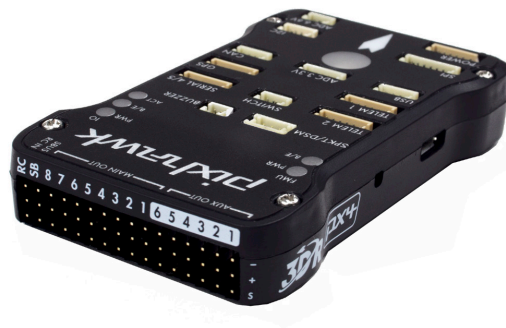
Figura C.9: Piloto automático Pixhawk.
