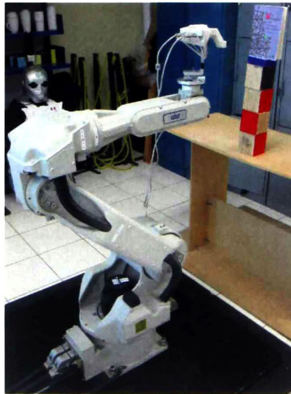
Figura 5.11: Sistema estéreo montado en el efector final del brazo robótico. (a) Un esquema representativo. (b) Área de trabajo real.
