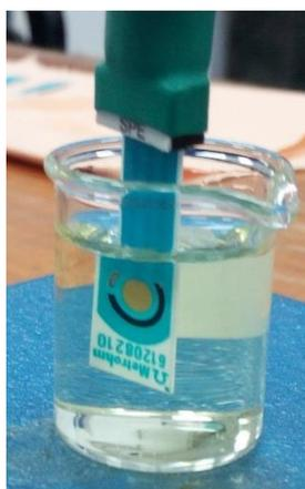
Fig. 24. Electrodeposito de  $\text{NpAu}$  sobre la superficie del electrodo de trabajo del AuSPE.
