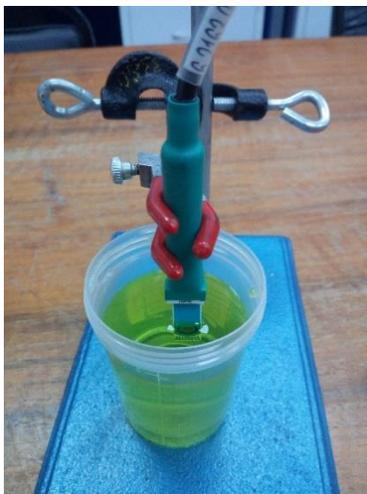
Fig. 33. AuSPE sumergido en solución de  $K_3[Fe(CN)_6]/KCl$  para evaluación electroquímica de la superficie de trabajo.
