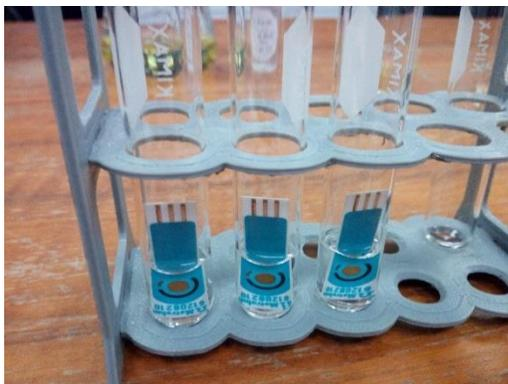
Fig. 27. AuSPEs sumergidos en una solución de CYS a 20 mM preparada en etanol:agua al 9:1.
