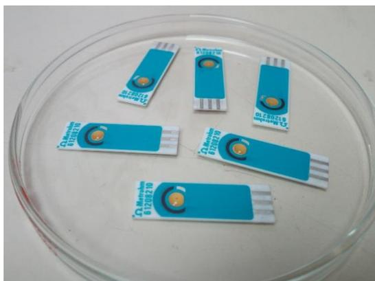
Fig. 29. AuSPEs con solución de la enzima Uox en sus electrodos de trabajo.
