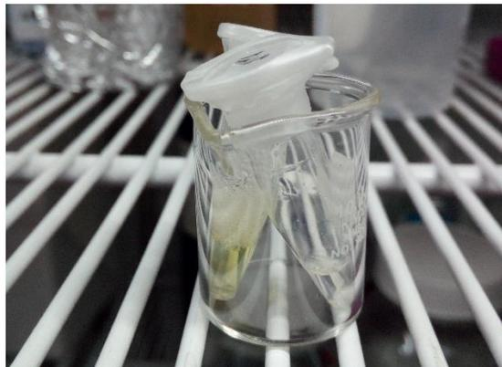
Fig. 32. Tubos Eppendorf con alícuotas enzimáticas de Uox sellados con parafilm. Con una tonalidad amarillenta se identifica la alícuota de Uox con glutaraldehído.
