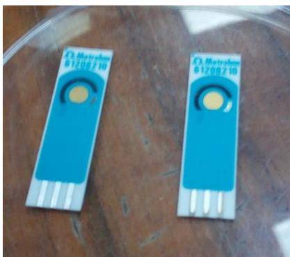
Fig. 25. Comparativa entre un AuSPE con NpAu electrodepositadas en su electrodo de trabajo (izquierda) y un AuSPE sin tratamiento (derecha).
