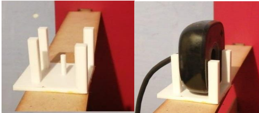
Fig. 8: Piezas de sujeción y ensamble con las piezas impresas
