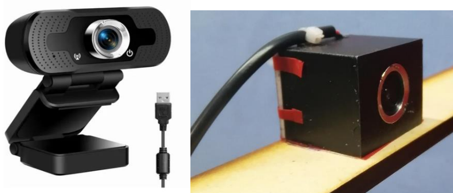
Fig. 39: Cámara web actualizada en su base original (izquierda) y en la carcasa hecha para la estructura (Derecha)
