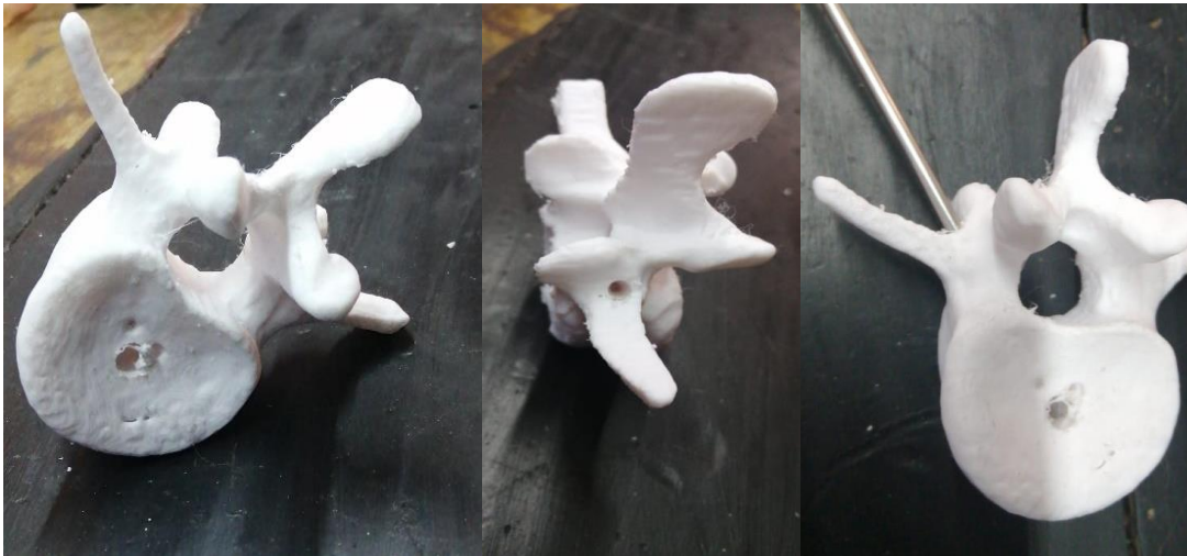
Fig. 2: Vertebra impresa en PLA, con perforación para herramental
