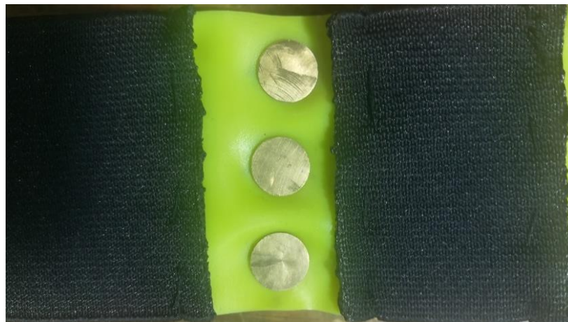
Figura 20. Placa de los electrodos secos de latón montada en la silicona para integrar los sensores al wearable.
