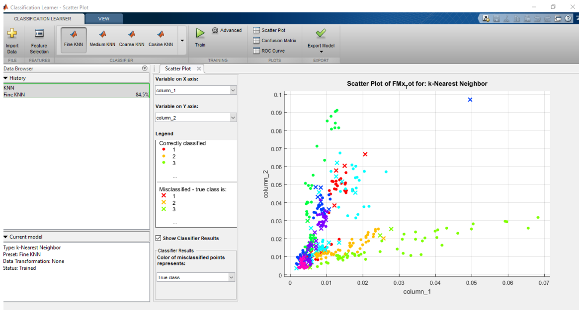
Figura 66. Clasificación all vs all utilizando KNN mediante la aplicación de Matlab “Classification Learner” utilizando un K=10 y obteniendo los valores de MAV mediante ventaneo. El porcentaje de clasificación en este experimento es de 84.5%.
