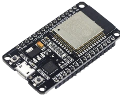
Figura 26. Tarjeta ESP-32 utilizada para la conversión análogo/digital y la comunicación USART con la computadora para el registro y almacenamiento de los datos.
