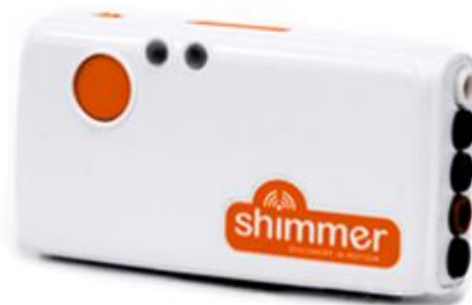
Figura 36. Sensor Shimmer3 EMG. El Sistema es conectado a electrodos húmedos para realizar el sensado y transmite la información por medio de bluetooth al sistema principal.
