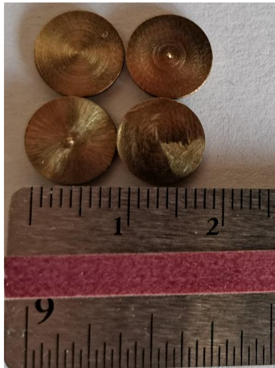
Figura 19. Electrodo de latón en forma de moneda utilizado para el registro de las señales sEMG. Tienen 9 mm de diámetro, 1 mm de grosor.
