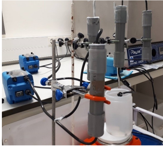
Figura 9. Sistema de biofiltración utilizando cartuchos de PVC.
