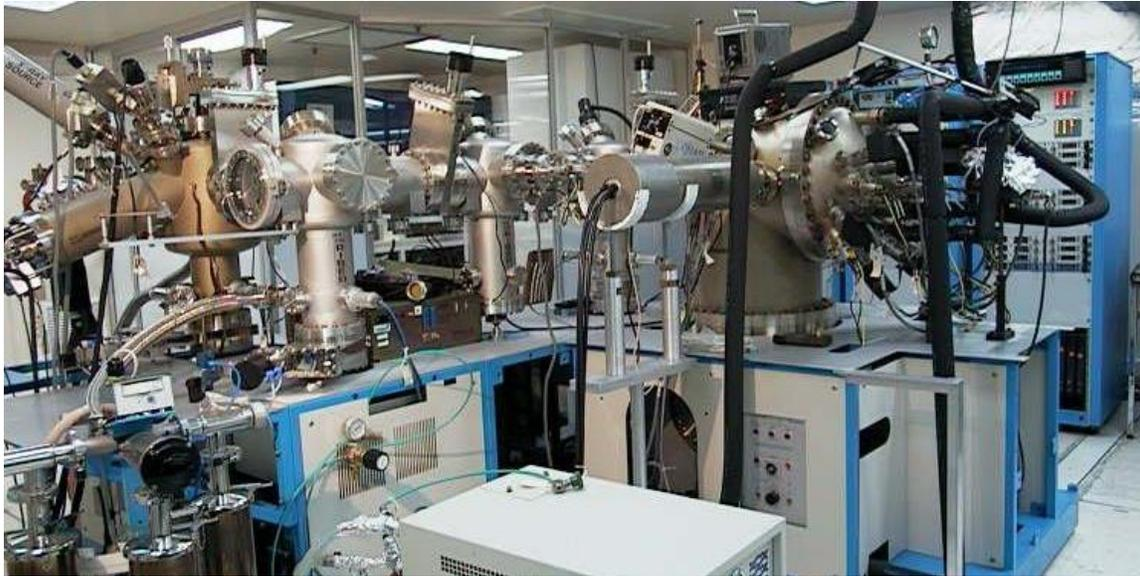
Figura 3.1. Sistema de crecimiento MBE Riber 32P para crecimientos epitaxiales de materiales semiconductores II-VI, equipado con ocho celdas de efusión, un cañón de electrones para caracterización RHEED, presión base de  $4 \times 10^{-11}$  Torr. El sistema de crecimiento pertenece al grupo NanoSem, del departamento de Física, Cinvestav.
