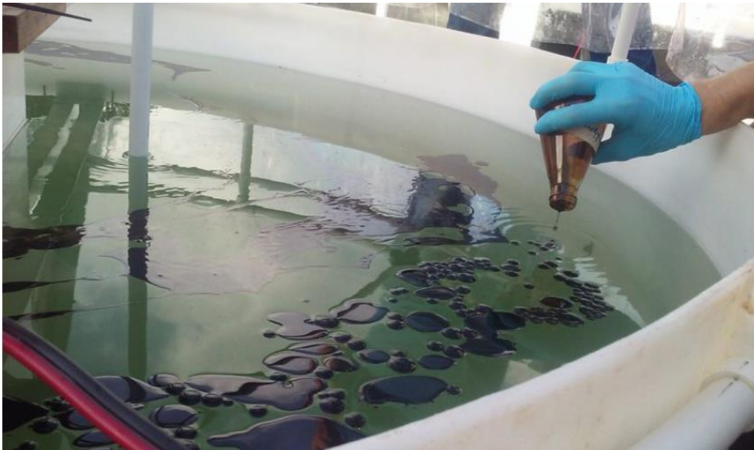
Fig. 22: Experimento de degradación de hidrocarburos a meso-escala (2500 litros) con agua marina proveniente del Golfo de México.
