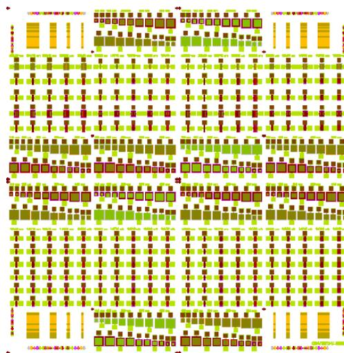
Figura 3.3. Topologías ocupadas en la fabricación de los dispositivos MDM, MDS y TFT.
