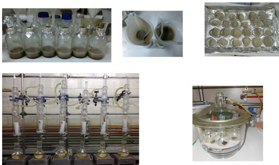
Figura 13. Lavado de suelos y extracción de hidrocarburos
